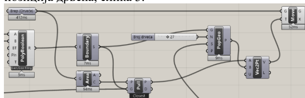
Слика 3: део кода који веже геометрију дрвеша за насумичне тачке на површи
