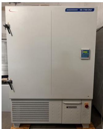
Slika 2. Klimatska komora Kambič KK-1700CHLT [10]
