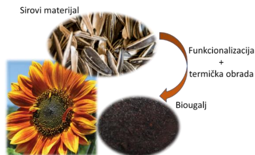
Slika 1. Sinteza biougla na bazi suncokretovih ljuski
