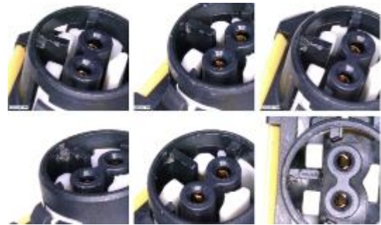
Slika 12 - Oštećenja na konektorima
