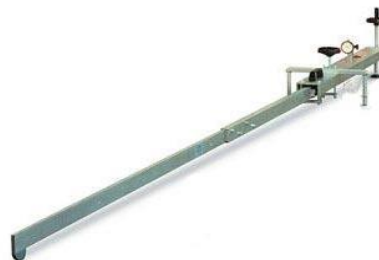
SLIKA 1 - BENKELMANOVA GREDA [6] Trenutno u svetu najzastupljeniji ugibomer sa padajućim teretom je "FWD - Falling Weight Deflectometer".
