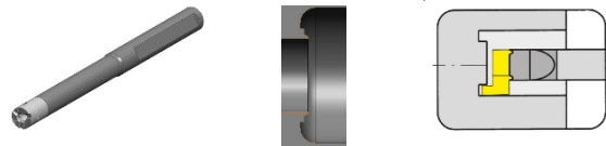
Slika 7. Nosač, prikaz dizne i tipa obrade struganjem [6]
