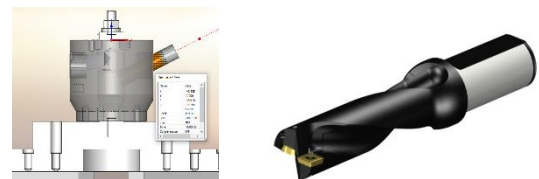
Slika 8. Operacija izrade otvora po uglom i prikaz alata [7]
