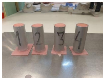
Slika 1. 4 aluminijumske epruvete napunjene sa PMMA korišćene za eksperiment
