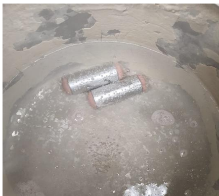
Slika 2. Proces polimerizacije PMMA kod ključanja vode
