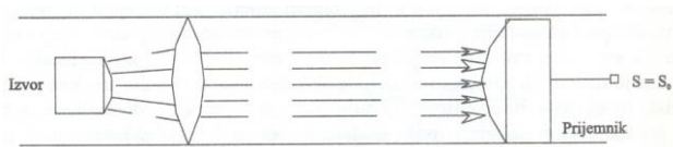
Слика 4. Комора оптичког детектора са директном светлошћу – стање без дима [4]
