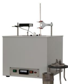
Slika 2. Prikaz Mahler-ovog kalorimetra
