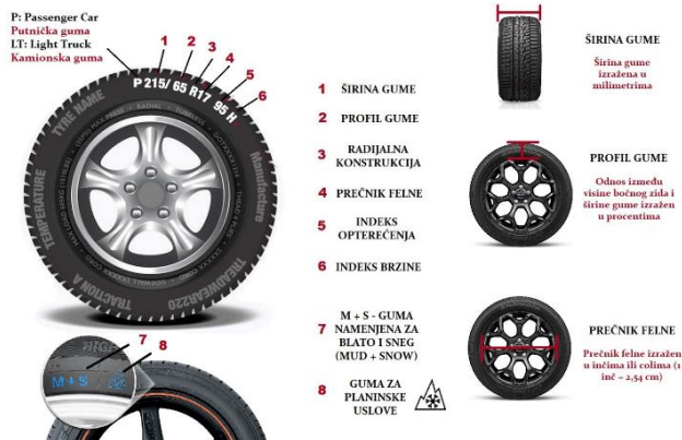
Slika 2. Osnovne i dodatne oznake na pneumaticima [4]
