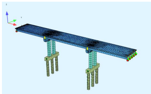
Слика 1. 3Д модел конструкције ног профила пута. Профил чине две коловозне траке са по две саобраћајне траке у сваком смеру раздвојене разделним острвом:
