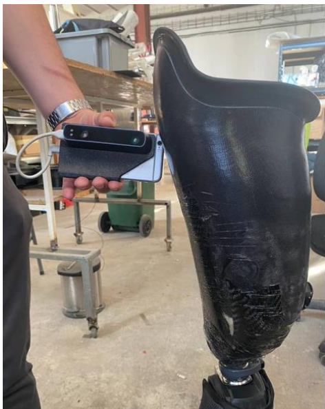
Slika 1. Proces skeniranja postojećeg ležišta ispitanika Structure Sensor skenerom
