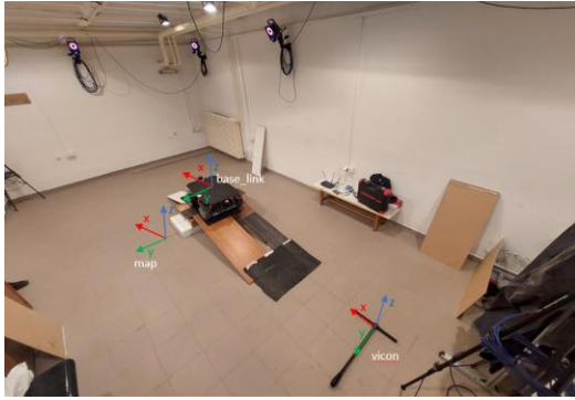
Slika 6. Kordinatni sistemi Vicon sistema, robota i mape
