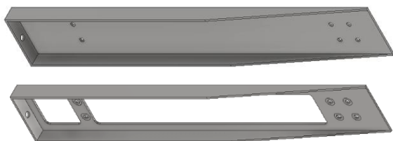
Slika 11. Izgled gornjeg dela oslonaca transportera pre i posle optimizacije
