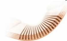
Слика број 1– Приказ начина савијања дрвета путем керф бендинг (енг. „Kerf Bending”) методе
