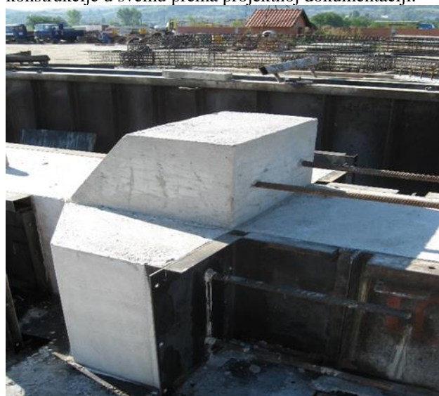
Slika 1. Proizvodnja AB elemenata
