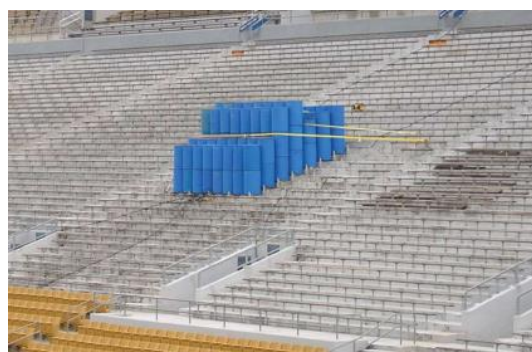
Слика 1 – Испитивање статичким пробним оптерећењем
