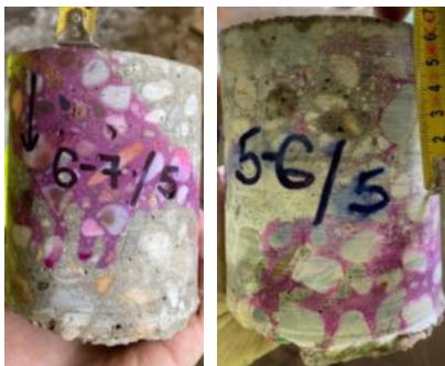
Слика 13 – Изглед бетонских кернова након прскања фенолфталеин индикатора
