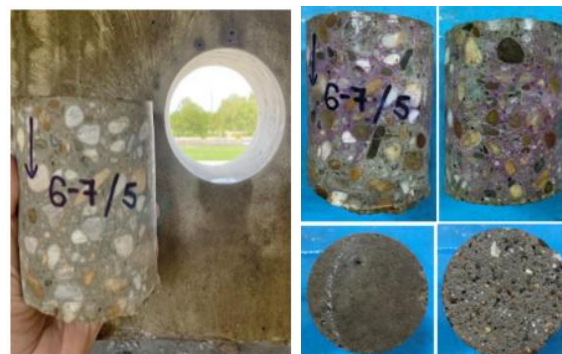
Слика 12 – Изглед бетонских језгара извађеног из АБ монтажне талпе (верикални део седишта трибина, сегмент 6-7/5)
