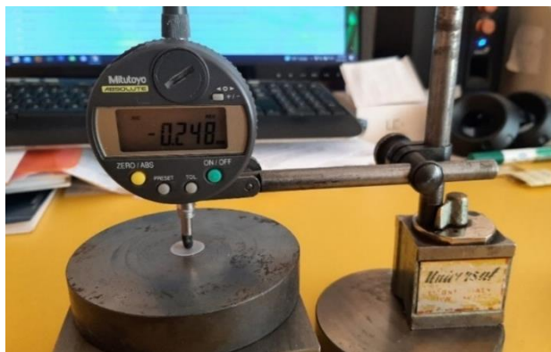
Slika 5. Komparator postavljen na univerzalni stalak, u kontaktu sa polimernom mernom pločicom
