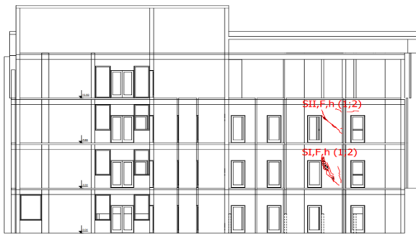
Slika 8. Podužni presek kroz osu F-F, h. Oštećenja u pregradnim zidovima od opeke
