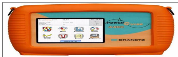
Sl. 2. Mrežni analizator Dranetz Power Guide 4400 [3]
