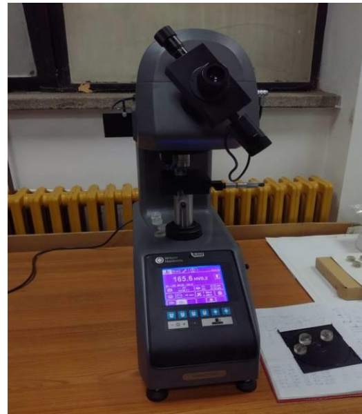
Slika 8 Uređaj za merenje mikrotvrdoće "Wilson Tukon 1102"
