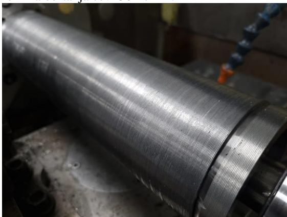
Slika 3 Obraden uzorak Ø88,9 x 320 mm
