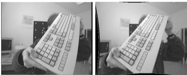
Slika 2. Uklanjanje distorzije kod široko-ugaonih sočiva
