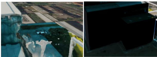
Slika 6. Greška u modelovanju Mesh modela usled nedovoljno gustog oblaka tačaka i neadekvatna tekstura CityGML modela
