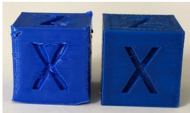
Slika 4. Poređenje početnog i završnog testiranja kalibracione kocke
