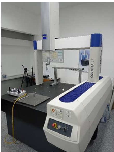
Slika 1. Koordinatna merna mašina Carl Zeiss CONTURA G2 RDS
