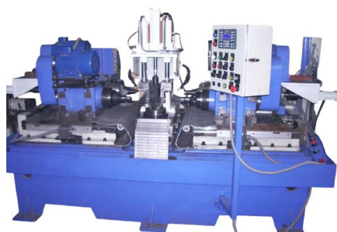
Slika 4. Fleksibilni tehnološki modul za obradu bušenjem i urezivanjem navoja, proizvođača "Patson Machines"
