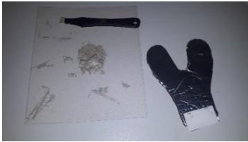
Slika 6. Prikaz izgleda sjedinjenog provodnog epoksida na levoj strani slike i primer zalepljene aluminijumske trakice na uzorak pomoću provodnog epoksida sa desne strane.
