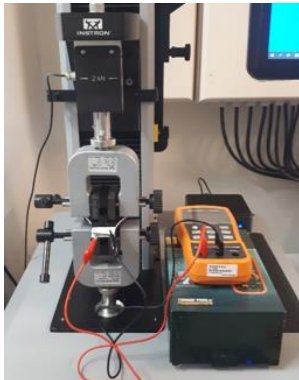
Slika 7. Prikaz merenja kapacitivnosti uzorka zagrizu od fondana, debljine 3 mm sa provodnikom od Al.
