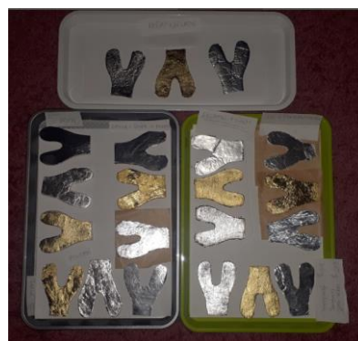
Slika 4. Izgled svih pločastih kondenzatora tj senzora zagriža nakon nanošenja provodnika od zlata (Au), srebra (Ag) i aluminijuma (Al).
