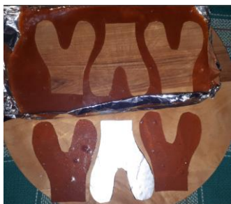
Slika 3. Prikaz finalnih senzora zagriža napravljenih od želatina i džema, debljina 3 mm.
