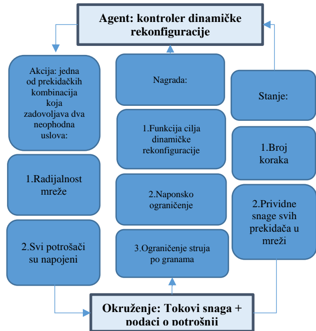
Slika 4.1.1. Interakcija agenta i okruženja za dinamičku rekonfiguraciju DM
