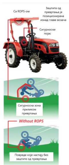
Slika 4. Zaštita od prevrtanja [6]
