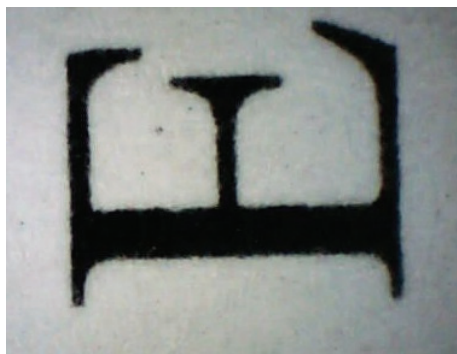
Slika 2. Izgled snimljenog slovnog karaktera "E" (4pt Times New Roman) na papiru gramature od 120 \text{g/m}^2
