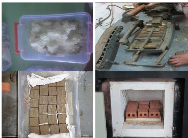
Slika 4. Proces proizvodnje opeke sa staklenim reciklatom
