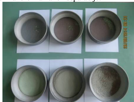
Slika 3. Granulometrijska sita sa praškastim uzorcima dobijenih mlevenjem otpadnog ambalažnog stakla
