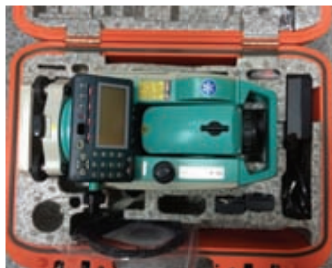
Сл. 2: Тотална станица Sokkia SET 630 RK коришћена за снимање комуналних уређаја који се обрађују у овом раду
