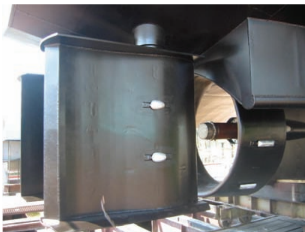
Slika 4. Postavljanje anoda na kormilo i osovinski vod
