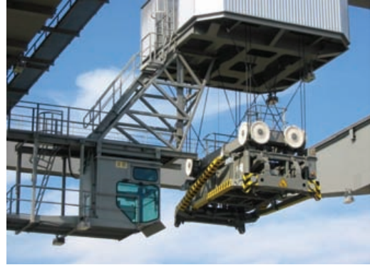
Slika 1. Mehanizmom za dizanje tereta sa 16-krakim šnjiarnjem užadi
