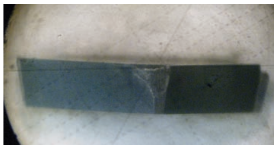
Slika 5. Izgled pohabane pločice
