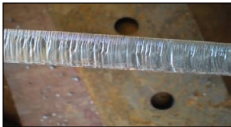
Slika 10. Slučaj rezanja sa izraženim tragovima rezanja
