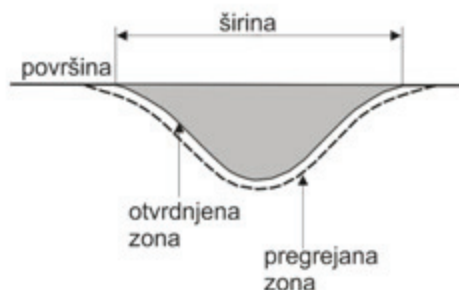
Slika 4. Presek zone povećane tvrdoće u metalu
