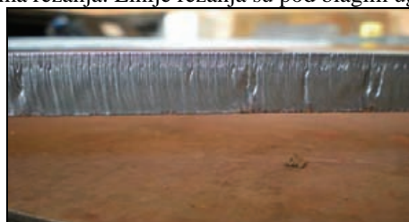
Slika 9. Izrezan materijal sa blago vidljivim tragovima rezanja
