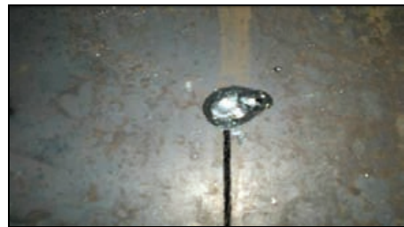
Slika 8. Nepotpuno izrezan materijal sa očvrslim rastopljenim materijalom na površini obratka
