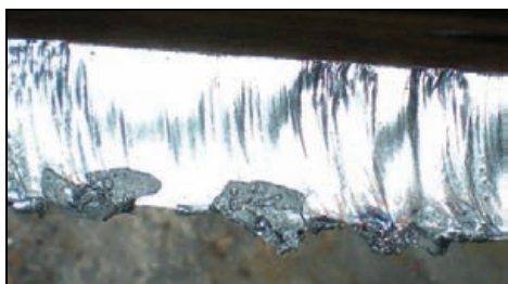
Slika 12. Rez sa izraženim srhovima u donjem delu
