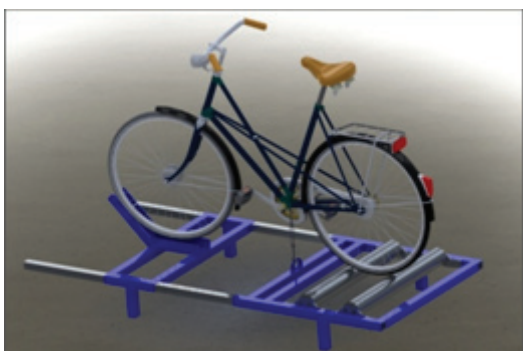
Slika 2. Izgled kompjuterskog nacrtu projekta platforme za testiranje električnog bicikla
