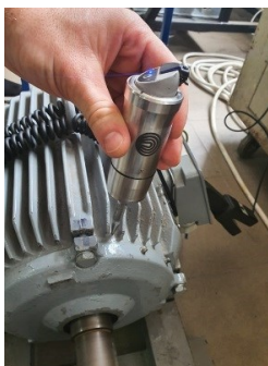
Slika 3. Bežični troaksijalni akcelerometar u radu
