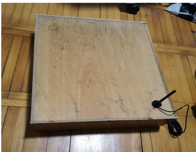
Slika 8. Izgled drvenog postolja stavljenog na samu vagu
