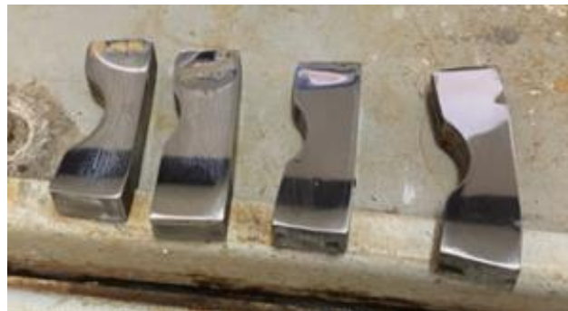
Slika 5. Ispolirani i očišćeni uzorci
