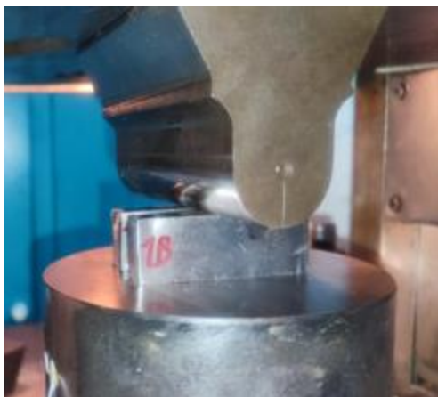
Slika 3. Utiskivanje žiga u materijal
