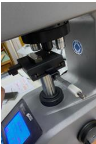
Slika 6. Proces merenja tvrdoće i merenje dijagonala otiska
