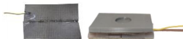
Slika 6. Prikaz tekstilne trake i prikaz sklopljenog senzora sa postoljem spremnim za merenja
