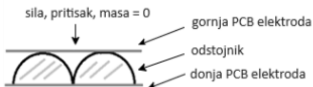
Slika 1. Poprečni presek senzora sa PCB elektrodama
