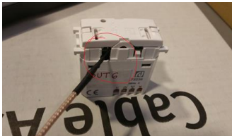
Slika 9. Kompletno kolo sa projektovanom antenom i merni kabl V.FL-2LPG-062N2D-A-(35)
