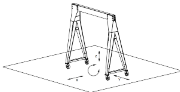
Слика 2. Могућа радна кретања радионичке порталне дизалице
