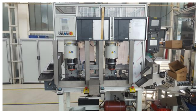
Slika 2. Radna stanica automatizovanog, robotizovanog sistema za rivetovanje kompanije „Bosch“ u Šimanovcima
