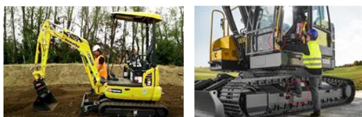
Слика 3. Заустављање багера (лево) и безбедно силажење (десно)
