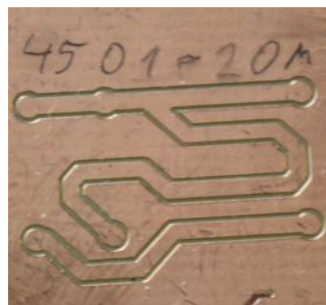
Slika 5. Korišćenje drugog motora sa glodalom V tipa ugaonog raspona od 45^\circ i širine 0.1mm, dubina glodanja je 20\mu\text{m}
