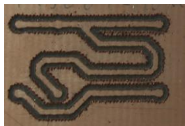
Slika 10. Korišćenje drugog motora sa spiralnim glodalom ugaonog raspona od 30^\circ i širine 0.1\text{mm} , dubina glodanja je 40\mu\text{m} , dok je brzina 7500 obrtaja u minuti
