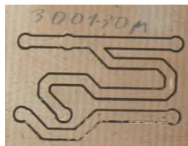
Slika 6. Korišćenje drugog motora sa glodalom V tipa ugaonog raspona od 30^\circ i širine 0.1mm, dubina glodanja je 30\mu\text{m} , dok je brzina 3000 obrtaja u minuti
