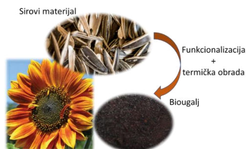
Slika 1. Sinteza biougla na bazi suncokretovih ljuski
