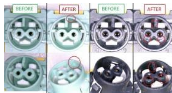
Slika 14 - Konektor pre i posle testiranja
