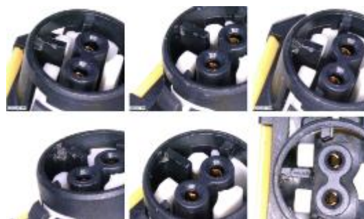
Slika 12 - Oštećenja na konektorima
