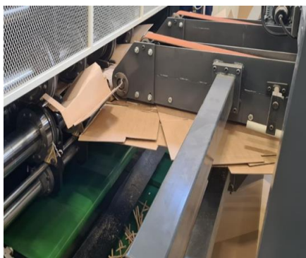
Slika 16 - Zastoj usled nagomilavanja
