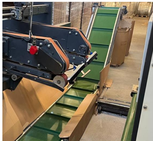
Slika 17 - Postavljene četke na tehnološki sistem
