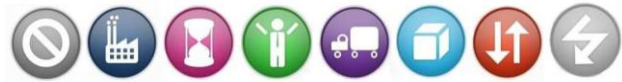
Слика 2. Осам LEAN губитака (DOWNTIME – Дефекти, Прекомерна производња, Чекање, Неискоришћени таленти, Транспорт, Инвентар, Покрет, Додатна обрада)
