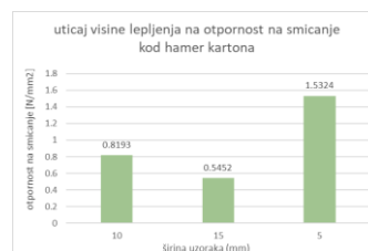
Slika 9. Uticaj visine lepljenja epruvete na otpornost na smicanje kod hamer kartona
