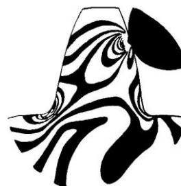
Slika 1. Prikaz koncentracije napona u zubu [1]
