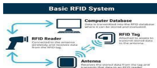
Слика 2. компоненте „RFID” система [19]
