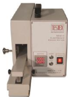
Slika 2. Testex TF411 Electronic Crock Meter [4]
